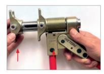
5. Переведите ручку тисков в верхнее положение, потяните вниз блокиратор, чтобы разъединить рычаг и насадку на тиски, вытащите осевые болты, установите необходимую насадку на тиски, зафикисруйте осевой болт и верните в исходное положение блокиратор.
