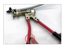
8. Потяните вниз блокиратор, чтобы разъединить рычаг и насадку на тиски, поднимите ручку тисков в верхнее положение, тиски автоматически разъединятся.
