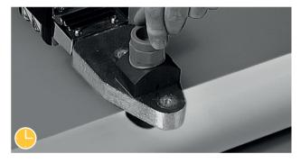
Затем седло следует точно и плотно, избегая вращения, прижать к нагретой наружной поверхности трубы, неподвижно фиксируя в течение 15 секунд.
