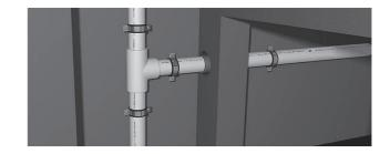
**При скрытой прокладке**, обеспечив расположение хомута жесткого крепления перед каждым ответвлением трубы, разрешается пренебрегать линейным расширением в случае использования армированных стекловолокном труб, т. е. устанавливать стояки без компенсационных колен. В таком случае образующееся линейное расширение между жесткими опорами не оказывает отрицательного воздействия. При этом необходимо следить за тем, чтобы расстояние между неподвижными опорами на стояках не превышало 3 метров.
