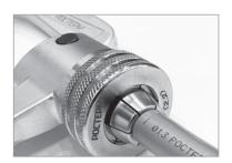
3. Проведите экспандирование трубы PE-X в три этапа (30%, 70%, 100%), между этапами проворачивая экспандируемую трубу на 30° вокруг своей оси.
