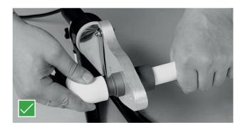
После окончания нагрева нужно снять трубу и фитинг с насадки и медленным поступательным движением произвести соединение элементов. Время с момента снятия с нагревательной плашки до момента соединения нагретых элементов не должно превышать указанного в таблице N° 5.
