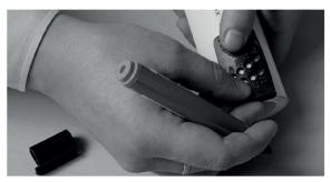
Для сварки трубы, армированной стекловолокном, рекомендуется обработать спиртосодержащим раствором внутреннюю сторону фитинга и наружный конец трубы. При этом также будут удалены частицы мелкого абразива и пыли, которые способны провоцировать повреждение тефлонового покрытия насадок сварного аппарата.
