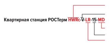
НWRc — для систем отопления и водоснабжения с рециркуляцией ГВС НW — для систем отопления и водоснабжения
