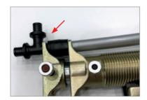
7. Проведите запрессовку до тех пор, пока гильза не соединится с кольцом фитинга полностью, рекомендуется избегать зазоров и несоосности соединения между фитингом и гильзой.
